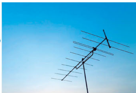
アナログアンテナ（VHFアンテナ）
